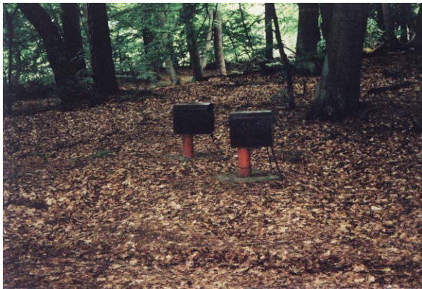
Stanowiska automatycznych pomiarów wahań zwierciadła wód gruntowych
