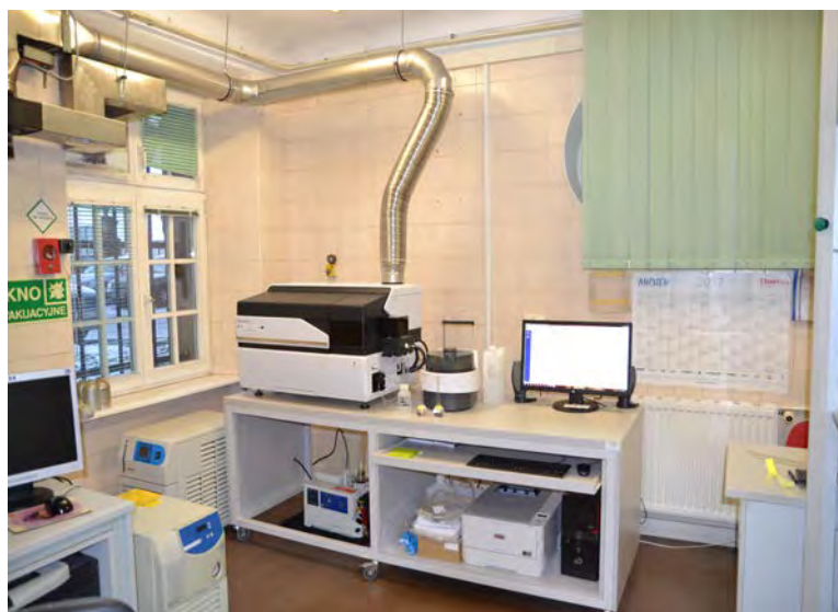
Fot. 7.2. Analizator do przepływowej analizy ciągłej CFA z detekcją spektrofotometryczną
