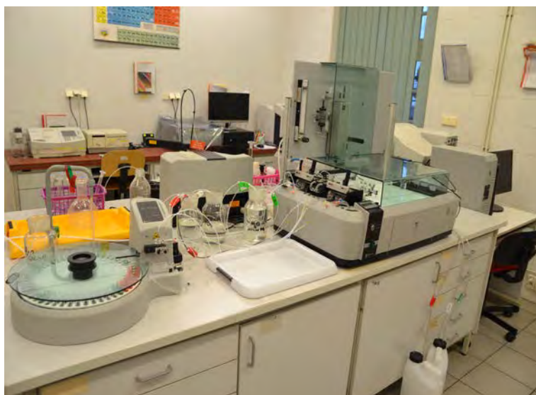
Fot. 7.2. Analizator do przepływowej analizy ciągłej CFA z detekcją spektrofotometryczną
