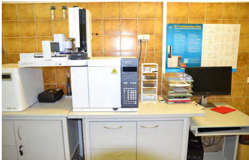
Fot. 7.3. Chromatograf gazowy z detektorem wychwyty elektronów GC-ECD
